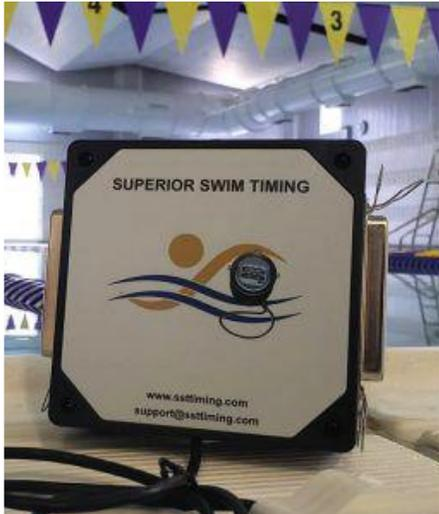
Das „Dongle“ der Zeitmessaanlage wird mittels USB-Anschluss mit dem Zeitmessaanlagenotebook „TEMPORA“ verbunden.
